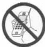
電氣裝置的設計要符合EMC要求，這樣在正常情況下就不會因為電磁干擾而出現故障。但是，若高頻發射器發出的無線電信號具有較高的發射強度，那 在電氣裝置附近工作時將產生電磁干擾且無法完全消除。
